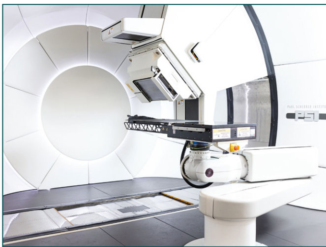
Gantry 3 am Zentrum für Protonentherapie des PSI. Mithilfe dieser drehbaren Behandlungsapparatur werden Krebskranke mit Protonen bestrahlt, um Tumore zu zerstören. Foto: Scanderbeg Sauer Photography
